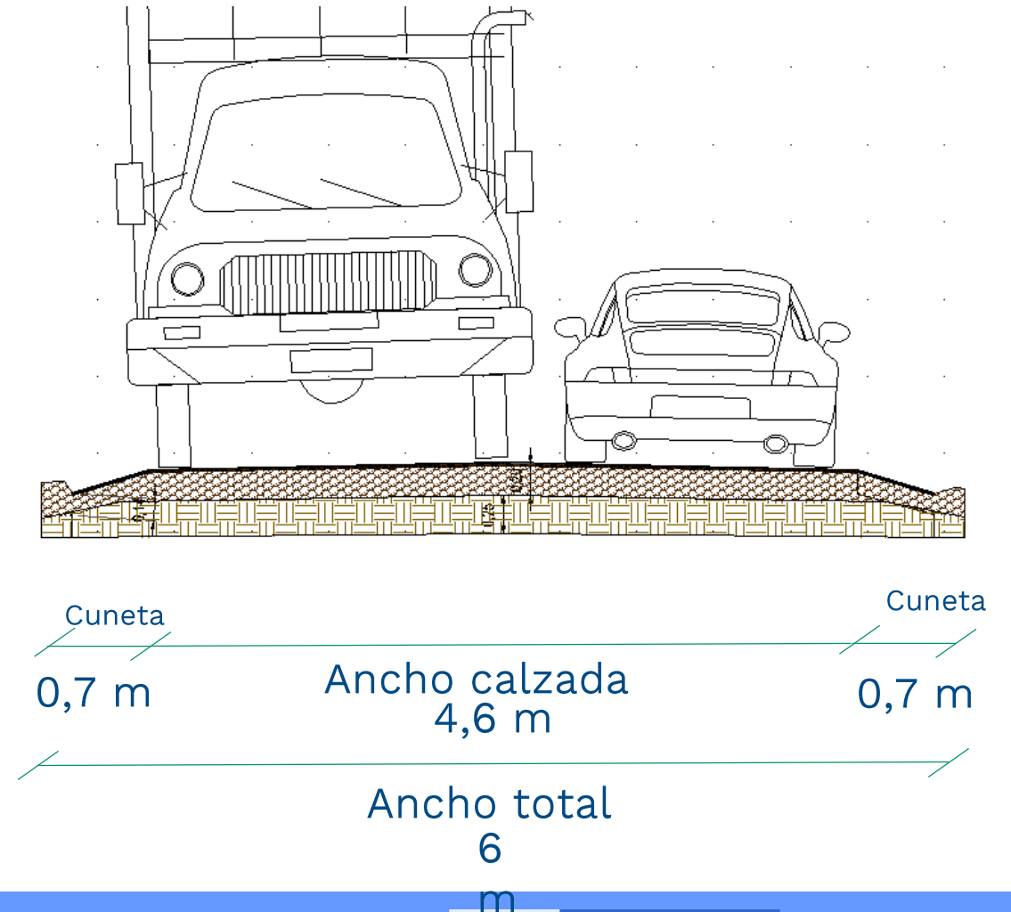
Cuneta perfilada (sin concreto)
