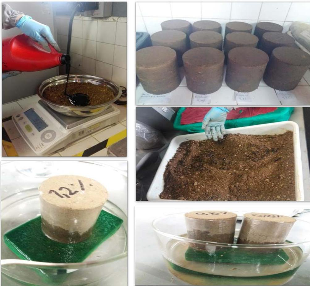
Imagen 23. Ensayos de laboratorio para determinación de la fórmula de trabajo de la empresa LA TIGRA MINING S. DE R.L SUCURSAL COLOMBIA
